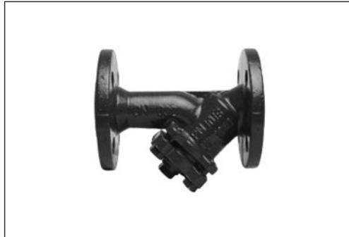
Фильтр сетчатый FVF предназначен для установки перед регулирующей арматурой, расходомерами, насосами с «мокрым» ротором электродвигателя и другими устройствами с повышенными требованиями к чистоте проходящей через них воды в системах отопления, теплоснабжения, технического горячего и холодного водоснабжения, а также для
